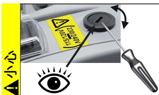
设置电压选择开关的电压范围：
