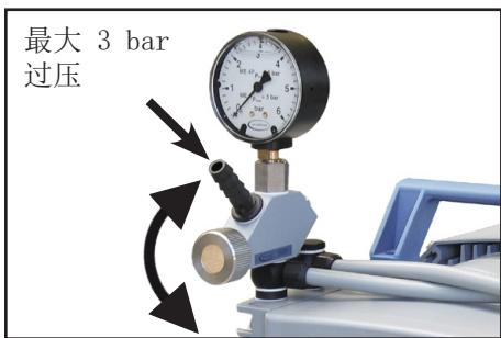
相应地，泵出口侧通过压力微调头来进行过压调节：
