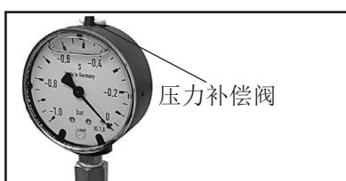
C: 带压力补偿阀的压力计
