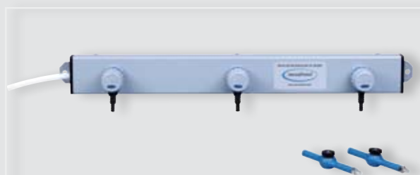
VACUU-LAN®迷你网路：3个可调端口，内置单向阀，防止并行应用的相互干扰（如，用于抽滤时）
