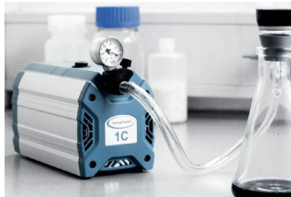
耐化学腐蚀的真空泵应用在抽滤实验上
