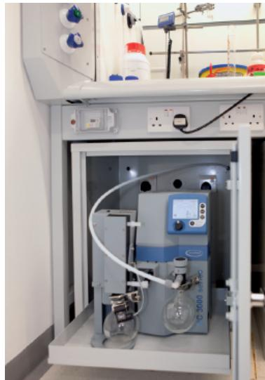
安装在通风橱里的真空网络，化学隔膜泵系统，配备了溶剂回收瓶。
