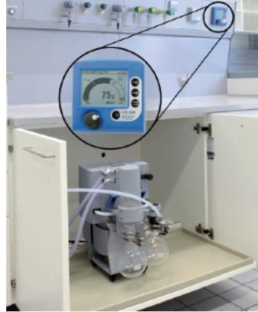
通风橱内安装真空网络，化学隔膜泵体系配备控制器和溶剂回收装置
