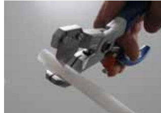
Einkürzen des PTFE-Rohres
