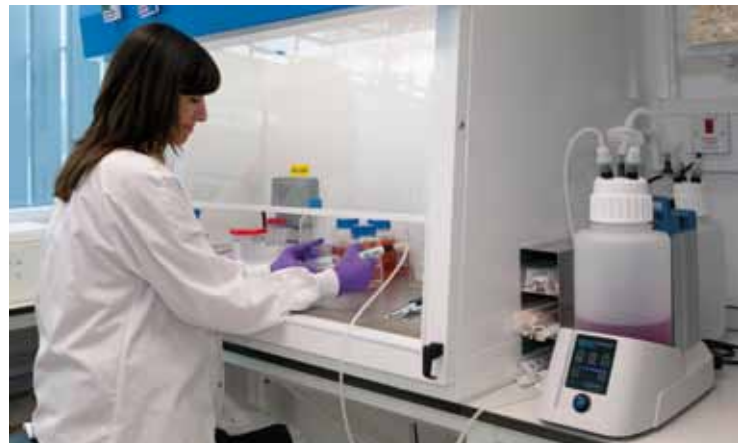
Einzelplatzversorgung: Grobvakuum, Flüssigkeitsabsaugung
