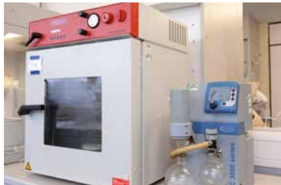
Trockenschrank mit Pumpstand
