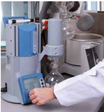
Einzelplatzversorgung: Grobvakuum mit einem chemiebeständigen Pumpstand am Rotationsverdampfer
