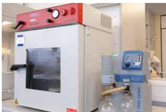
Étuve avec groupe de pompage
