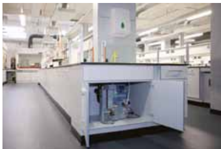
Une pompe, plusieurs utilisateurs : installation en réseau avec refroidissement Peltronic sans alimentation en eau, pour la récupération des solvants
