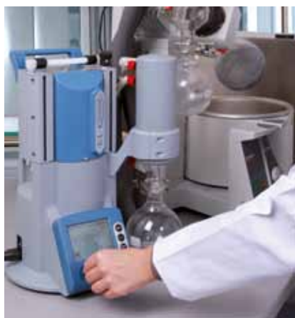
Système d'approvisionnement individuel : vide grossier avec un groupe de pompage résistant aux produits chimiques relié à un évaporateur rotatif
