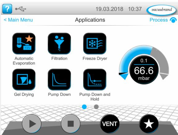
В VACUU·SELECT установлены готовые программы вакуумирования для большинства распространенных лабораторных задач. Этапы процесса и параметры вакуумного контроля можно легко отредактировать и сохранить нужные для Вашего процесса параметры, просто используйте следующую инструкцию:
