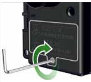
4. 将电池盒盖置于真空规上的正确位置,并用外加螺丝固定。拧紧时,请遵守0.4 Nm的最大扭矩。
