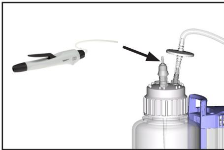
将 VacuuHandControl VHC<sup>pro</sup> 的软管套在瓶盖上的软管喷嘴接头上。
