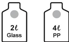
按键用于选择使用的瓶子大小(2 L 玻璃瓶或 4 L 聚丙烯瓶)并由此激活相应的液位传感器。操作时，请触摸字标“2l 玻璃”或“4l PP”超过 1 秒钟。所选瓶子的 LED 亮蓝光。
