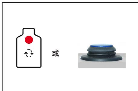
在更换收集瓶之前，请操作切换键(红色 LED 从闪烁变为常亮)或关断 BVC，确保在没有连接瓶子时泵不会运行。
