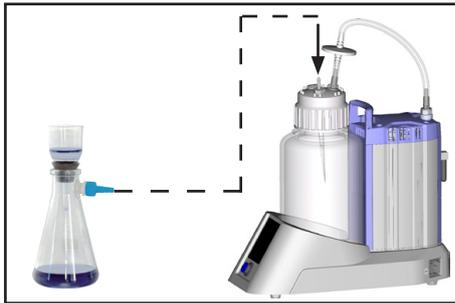
将抽吸瓶连接在瓶盖上 VacuuHandControl 的接口上或通过附加的软管喷嘴接头(附件, 订货号 638509)进行连接, 参见“BVC 瓶盖上软管喷嘴接头的安装”。
