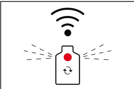
在正确校准并正确选择瓶子大小的情况下，液位传感器会在灌注体积约为 80% 时将泵关断。通过切换键瓶子符号中红色 LED 的闪烁和一个报警声音来确认这一情况。
