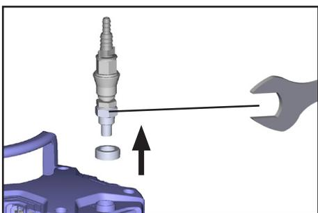
➔ 用开口扳手旋出软管喷嘴接头或带软管喷嘴接头的连接器。
