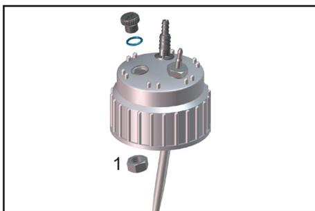
仅限带聚丙烯瓶的 BVC：松开螺旋盖中的锁紧螺母(1)。
