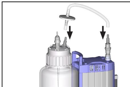
安装带过滤器的软管。
