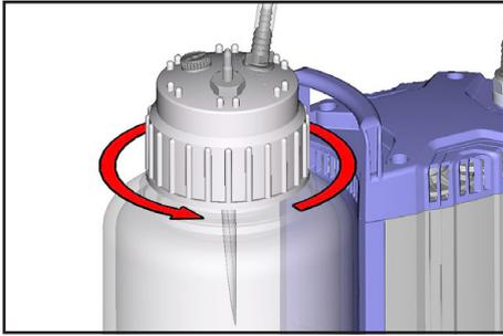
松开收集瓶的螺旋盖(在通风后)。
