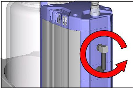
➔ 从泵出气口上旋出带消音器的弯管接头。
