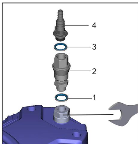
安装带密封圈(1、3)和软管喷嘴接头(4)的连接器(2)。
