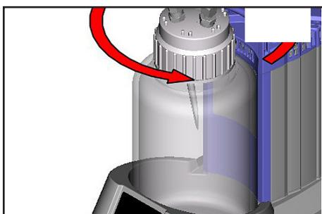
松开收集瓶的螺旋盖(在通风后)。
