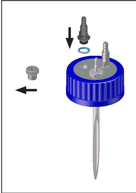
旋入带密封件的软管喷嘴接头。
