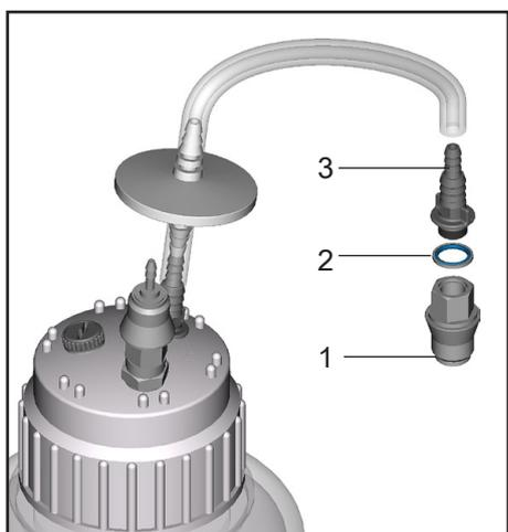
安装带密封圈(2)和软管喷嘴接头(3)的连接器(1)。
