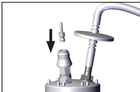
仅限带有用于连接 VacuuHandControl VHC<sup>pro</sup> 的快锁接头的 BVC
