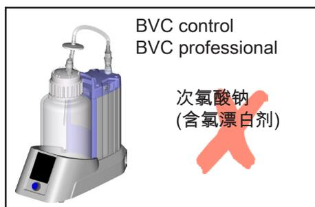
会释放氯或氧自由基的侵蚀性消毒剂，例如次氯酸钠(含氯漂白剂)或过氧化物，可能腐蚀 BVC 的 4 升收集瓶和其他组件的材料(聚丙烯)。这可能导致 4 升 PP 收集瓶出现应力裂纹和碎裂。
