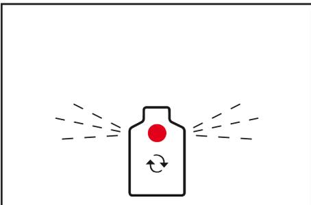
通过操作切换键(LED 下方)关闭报警声音并激活泵，LED 继续闪烁。
