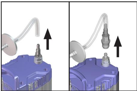
➔ 根据结构，拔下软管喷嘴接头上的连接软管或松开快锁接头。
