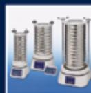
Tamiseuses de laboratoire avec mouvement de tamisage à trois dimensions et réglage entièrement électronique.
