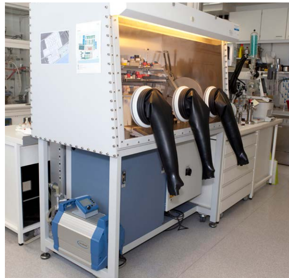
Glovebox in Kombination mit einer drehzahlgeregelten VARIO®-Membranpumpe
