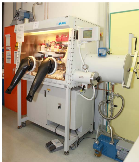
Figura 1: Cámara de guantes en la Univ. de Bremen con cámara de refrigeración e instalación para la recolección de solventes
