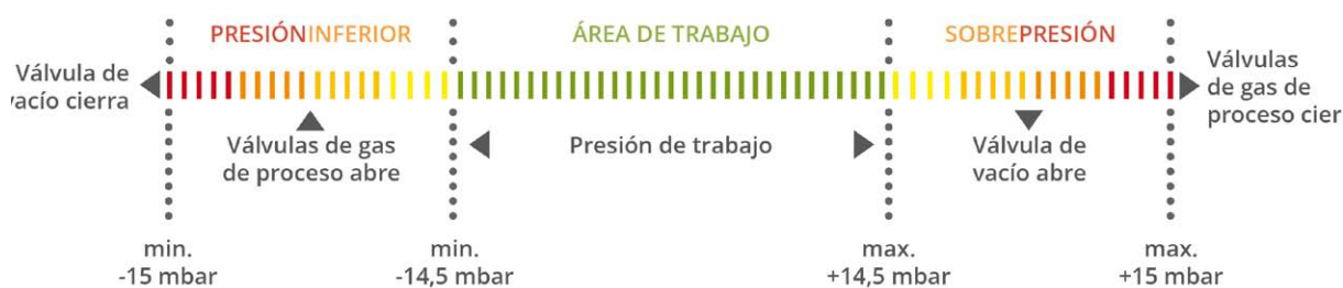
Figura 3: Diagrama de área de presión dentro de la caja de guantes.
