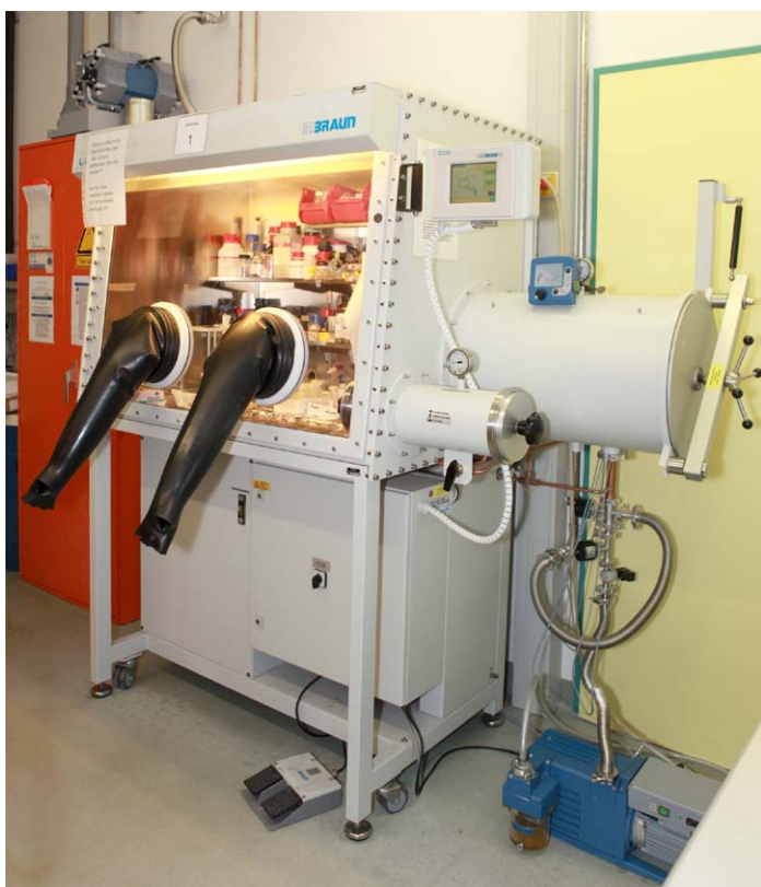
Figure 1, l'installation de boîte à gants à l'université de Brême avec chambre froide, l'installation pour l'évacuation des solvants, chambre de transfert avec pompe à vide et vacuomètre.
