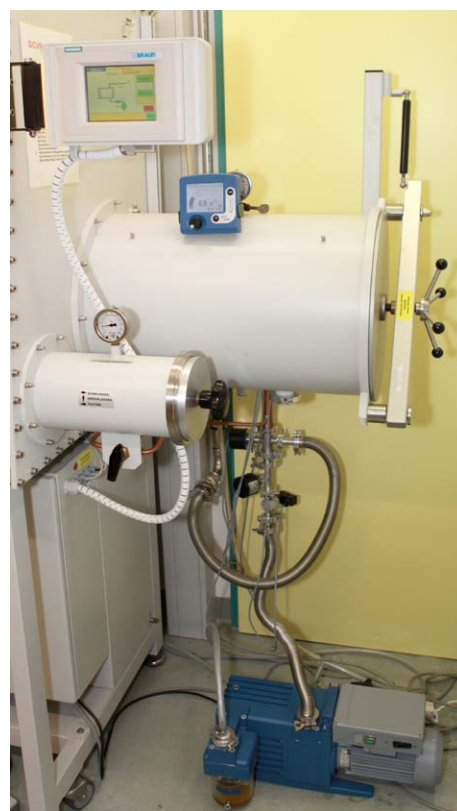
Figure 1, l'installation de boîte à gants à l'université de Brême avec chambre froide, l'installation pour l'évacuation des solvants, chambre de transfert avec pompe à vide et vacuomètre.
