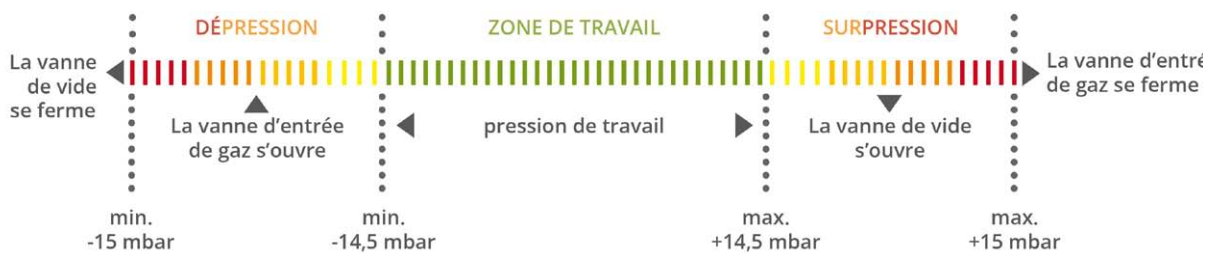
Figure 2 : diagramme de la variation de pression à l'intérieur de la boite à gants
