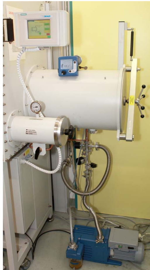
Abbildung 2: Transferkammern einer Glovebox-Anlage mit Vakuumpumpe und Vakuummessgerät
