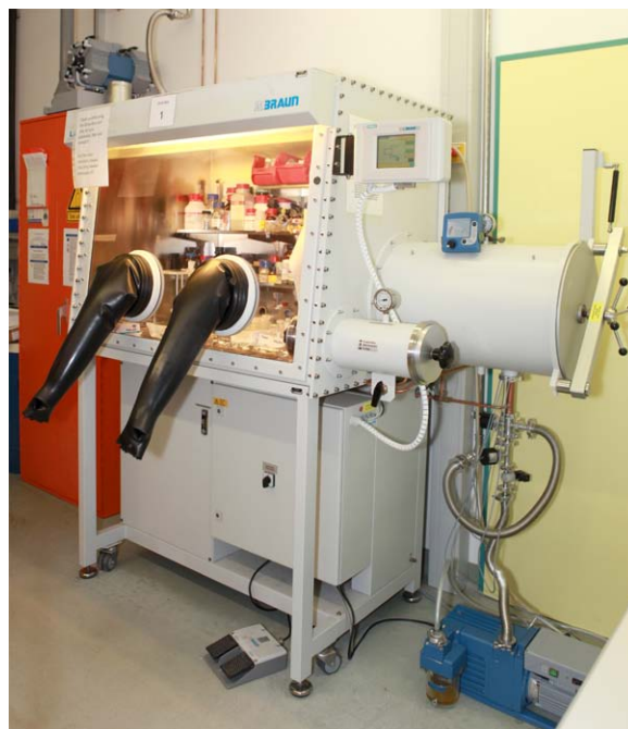
Abbildung 1: Glovebox-Anlage an der Universität Bremen mit Kühlkammer und Einrichtung zur Lösemittelentnahme
