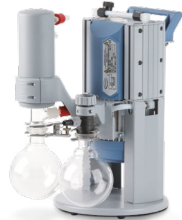
MD 1C +AK +EK Chemie-Membranpumpe 1.3 m 3 /h, 2 mbar Vakuumschluss: Schlauchwelle DN 8-10
