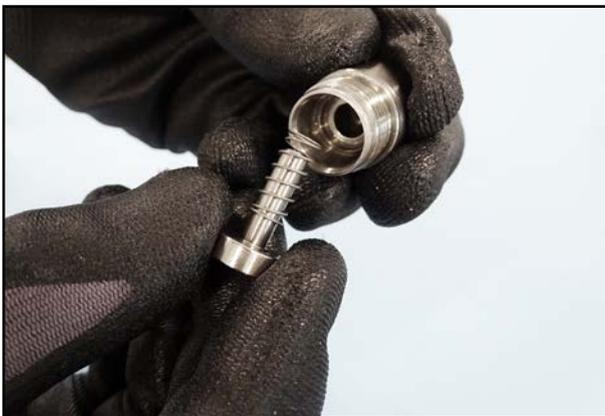
87. Setzen Sie das Ölrückhalteventil mit Gehäuse zusammen.
