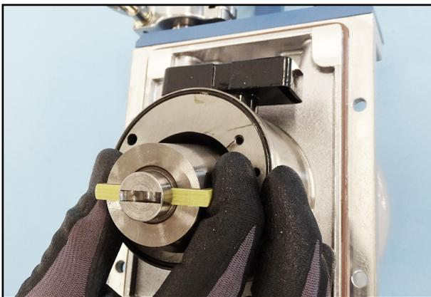
73. Setzen Sie den Rotor mit Schiebern in den Stator.
