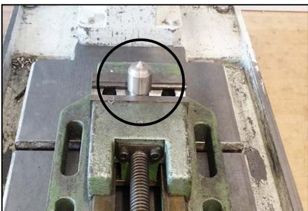
21. Spannen Sie einen Dorn ein, z. B. in einer Ständerbohrmaschine oder Handhebelpresse.
