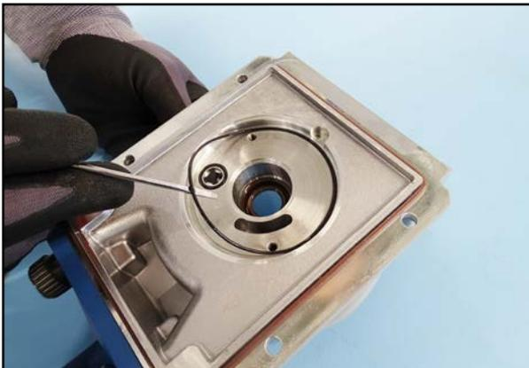
74. Legen Sie neue Dichtungen in das Gehäuse.
