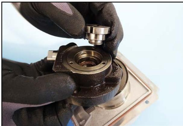
37. Heben Sie den Ölpumpenrotor aus dem Lagerdeckel.
