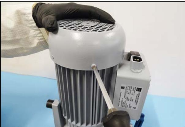
25. Fädeln Sie durch seitliches Kippen über das Lüfterrad die Lüfterhaube auf den Motorflansch.
