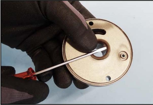
64. Drücken Sie die Wellendichtung mit Hilfe eines Schraubendrehers mit Flachklinge aus dem Lagerschild heraus.
