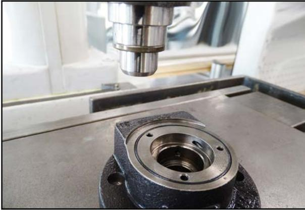
70. Spannen Sie den Einpressdorn 7 in eine Ständerbohrmaschine.
