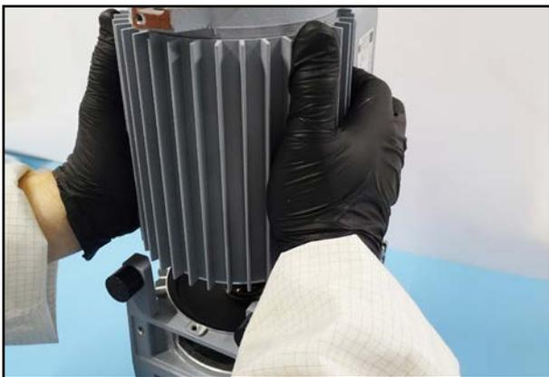
89. Setzen Sie den Motor vorsichtig in das Gehäuse.
