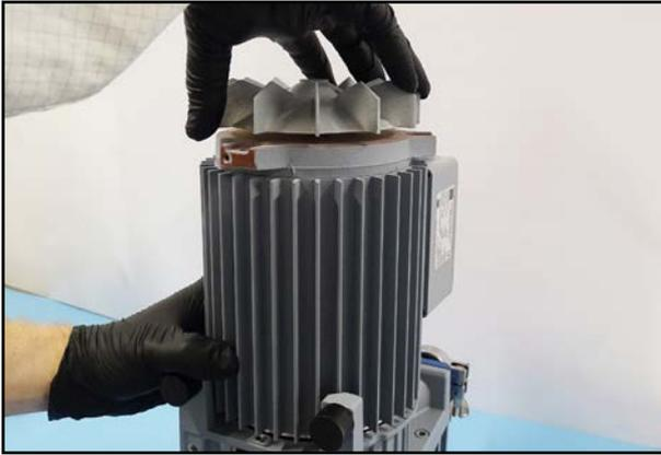
103. Drehen Sie leicht am Lüfterrad, bis der Motor komplett in das Gehäuse gleitet.
