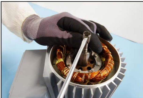
20. Schieben Sie mit Hilfe eines Schraubendrehers mit Flachklinge einen neuen Toleranzring über die Motorwelle.
