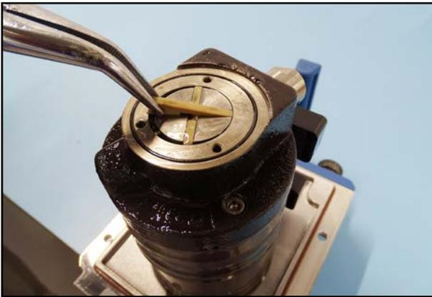
33. Ziehen Sie die Schieber aus dem Rotor heraus.
