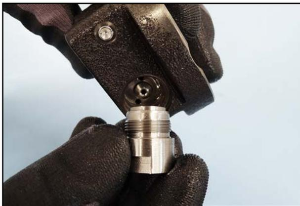
88. Schrauben Sie das Ölrückhalteventil in den Lagerdeckel.
