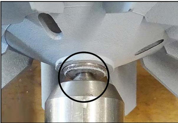
23. Positionieren Sie die Motorwelle als Gegenlager auf dem Dorn.
