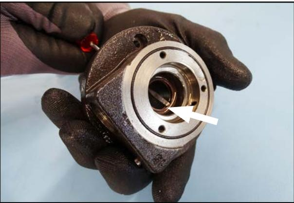
65. Drücken Sie die Wellendichtung mit Hilfe eines Schraubendrehers mit Flachklinge aus dem Lagerdeckel heraus.
