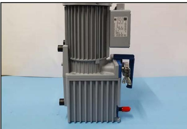
4. Stellen Sie die Pumpe auf den Ölkasten (auf das Typenschild).
