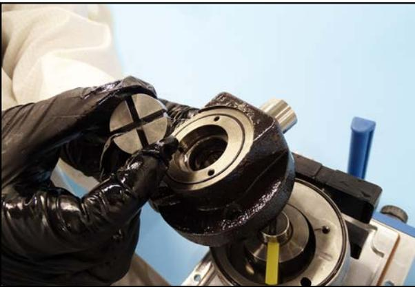
37. Nehmen Sie den Ölpumpenrotor aus dem Lagerdeckel.
