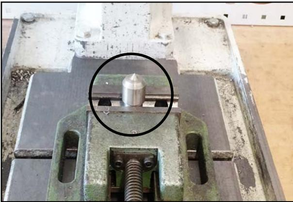
22. Spannen Sie einen Dorn ein, z. B. in einer Ständerbohrmaschine oder Handhebelpresse.
