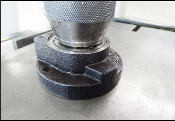
65. Pressen Sie die Wellendichtung bis auf Anschlag in den Lagerdeckel ein.
