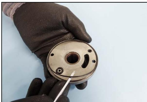
51. Entfernen Sie alle Dichtungen am Lagerschild.
