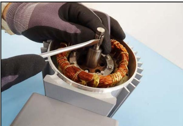
19. Entfernen Sie den Toleranzring von der Motorwelle mit einem Schraubendreher mit Flachklinge.
