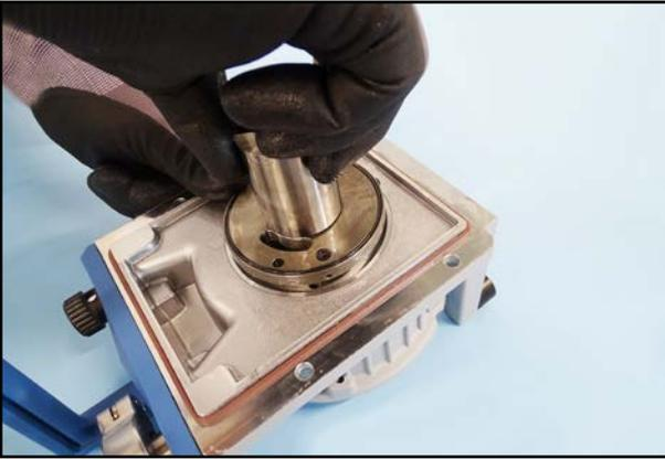
41. Heben Sie den Rotor und das Lagerschild ab.
