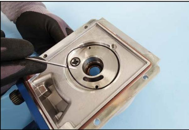
66. Legen Sie neue Dichtungen in das Gehäuse.
