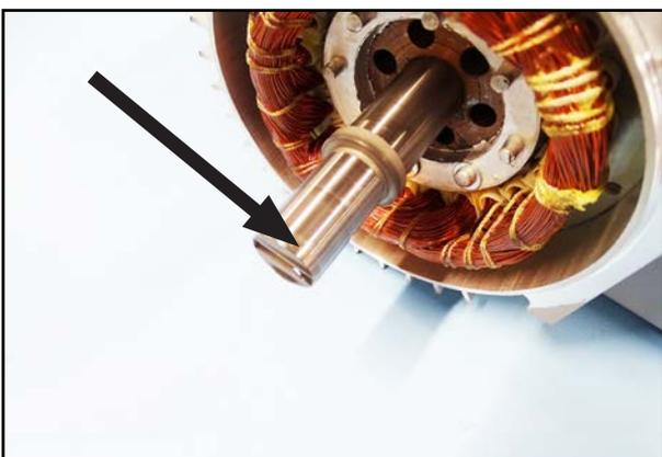
13. Kontrollieren Sie die Kupplung auf Einlaufspuren („Fingernagelprobe“).
