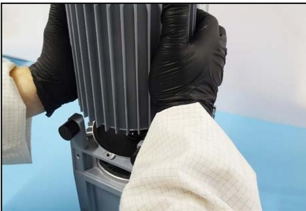
20. Setzen Sie den Motor vorsichtig in das Gehäuse.
