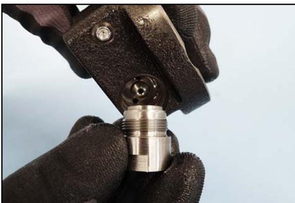
75. Schrauben Sie die Rückhalteeinrichtung in den Lagerdeckel.
