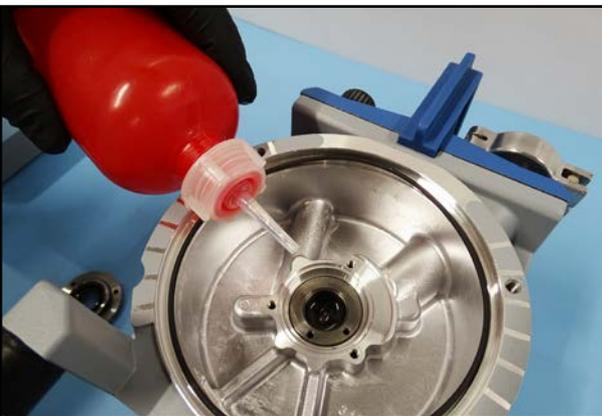
16. Füllen Sie den Raum vor der Wechselhülse mit dem Vakuumpumpenöl, mit dem Sie die Pumpe betreiben.
