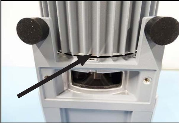
⇒ Beim Einsetzen des Motors kann ein Spalt entstehen.
