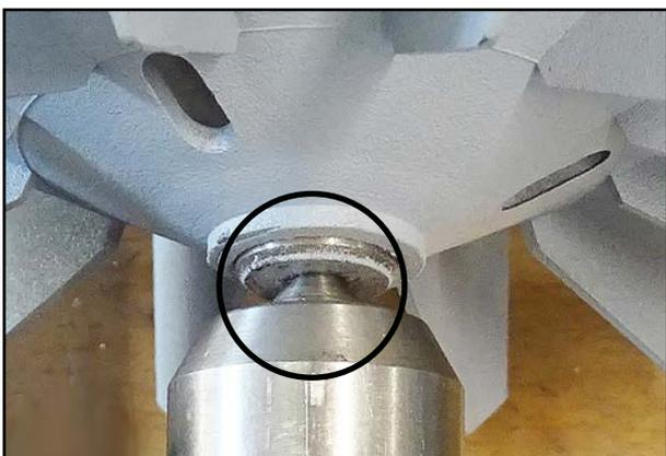
22. Positionieren Sie die Motorwelle als Gegenlager auf dem Dorn.
