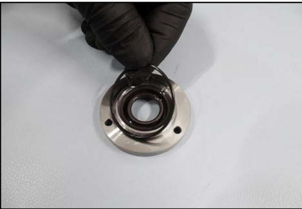
15. Legen Sie einen neuen O-Ring um die neue Wechselhülse.
