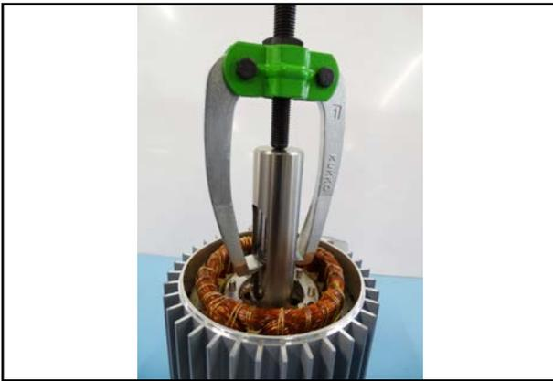
16. Positionieren Sie den Abzieher wie abgebildet auf der Abziehhülse und der Kupplung.
