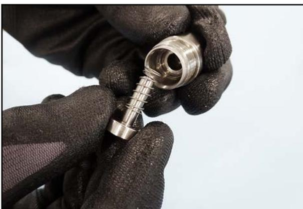
74. Setzen Sie das Ölrückhalteventil mit Gehäuse zusammen.
