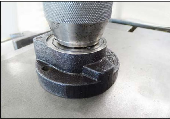
73. Pressen Sie die Wellendichtung bis auf Anschlag in den Lagerdeckel ein.
