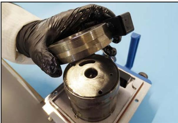
84. Montieren Sie den Ölabscheider und setzen Sie den Stator ein.
