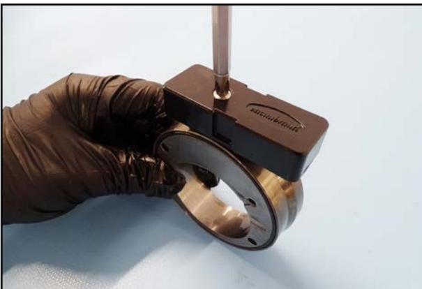
43. Schrauben Sie den Ölabscheider ab.
