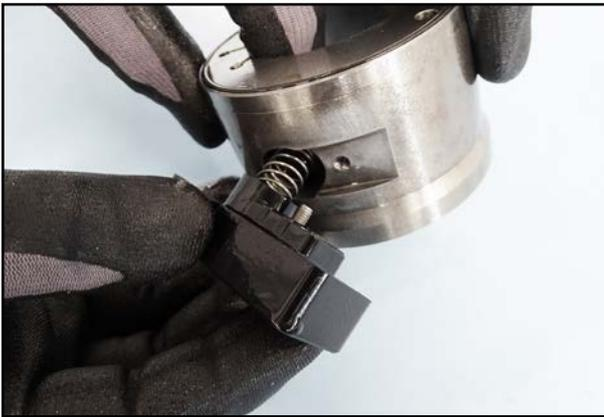
70. Setzen Sie den Ölabscheider mit Feder und Kappe in den Stator.
