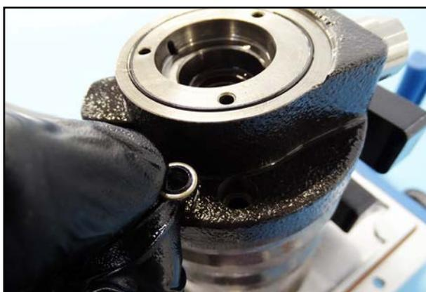
90. Legen Sie die Usit-Ringe in die Bohrungen des Lagerdeckels.
