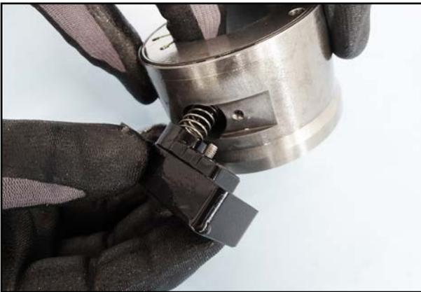
78. Setzen Sie den Ölabscheider mit Feder und Kappe in den Stator.
