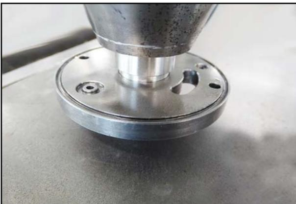
61. Pressen Sie die Wellendichtung bis auf Anschlag in das Lagerschild ein.
