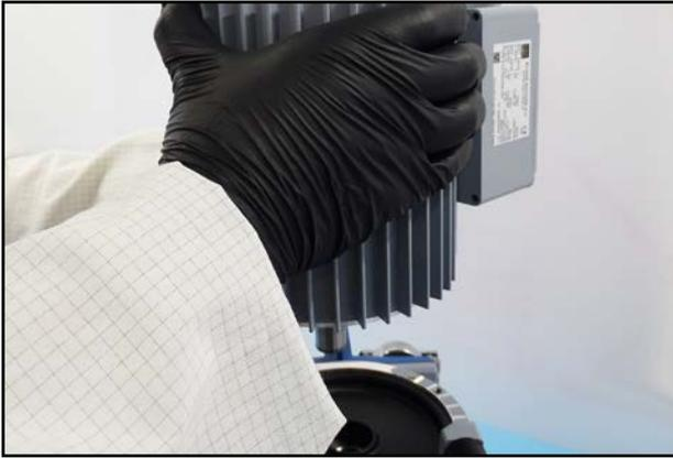
9. Heben Sie den Motor aus dem Gehäuse.
