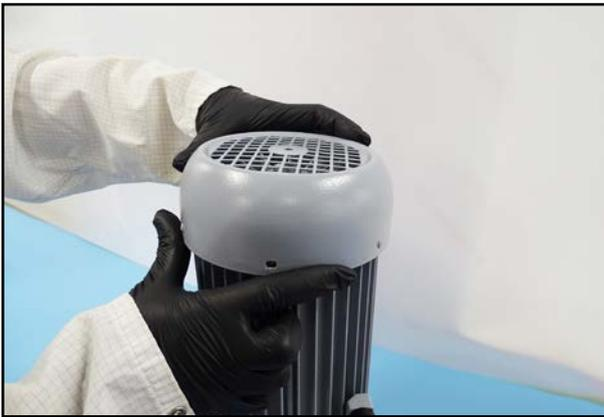
6. Heben Sie die Lüfterhaube durch seitliches Kippen über das Lüfterrad ab.
