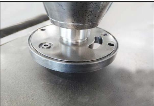
69. Pressen Sie die Wellendichtung bis auf Anschlag in das Lagerschild ein.
