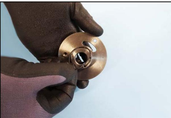
44. Entfernen Sie die Dichtung am Lagerschild auf der anderen Seite.
