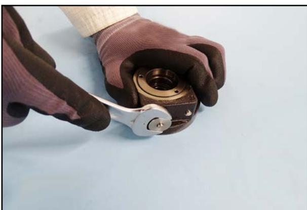
54. Schrauben Sie die Verschlusschraube des Ölrückhalteventils aus dem Lagerdeckel.
