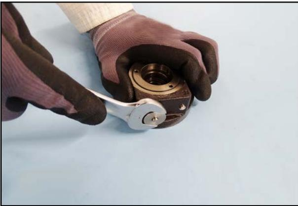
46. Schrauben Sie die Verschlusschraube des Ölrückhalteventils aus dem Lagerdeckel.
