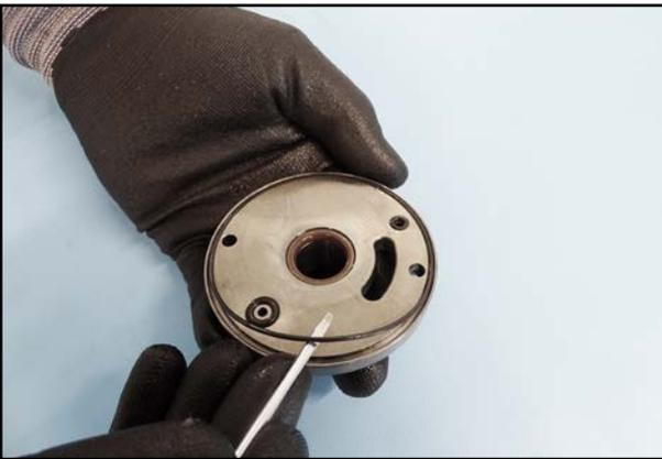
43. Entfernen Sie die Dichtungen am Lagerschild.
