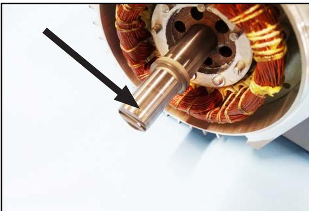
11. Kontrollieren Sie die Kupplung auf Einlaufspuren („Fingernagelprobe“).
