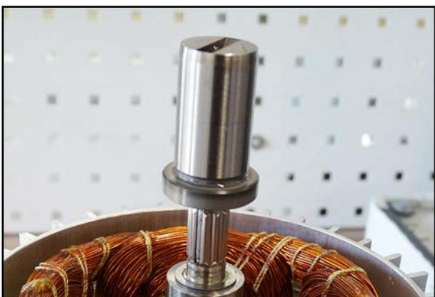
23. Setzen Sie die Kupplung auf die Motorwelle.
