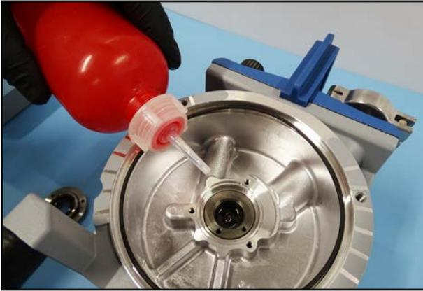
85. Füllen Sie den Raum vor der Wechselhülse mit dem Vakuumpumpenöl, mit dem Sie die Pumpe betreiben.
