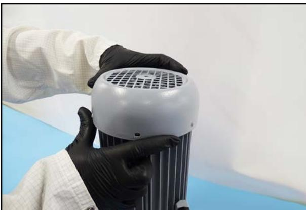
8. Heben Sie die Lüfterhaube durch seitliches Kippen über das Lüfterrad ab.
