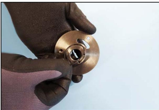
52. Entfernen Sie die Dichtung am Lagerschild auf der anderen Seite.
