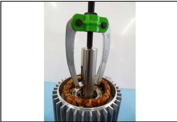
17. Positionieren Sie den Abzieher wie abgebildet auf der Abziehhülse und der Kupplung.
