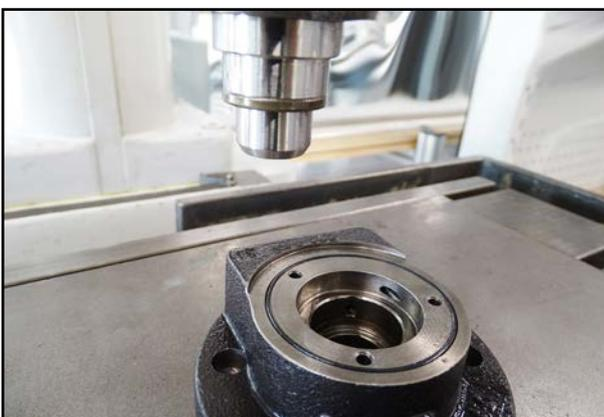
62. Spannen Sie den Einpressdorn 7 in eine Ständerbohrmaschine.
