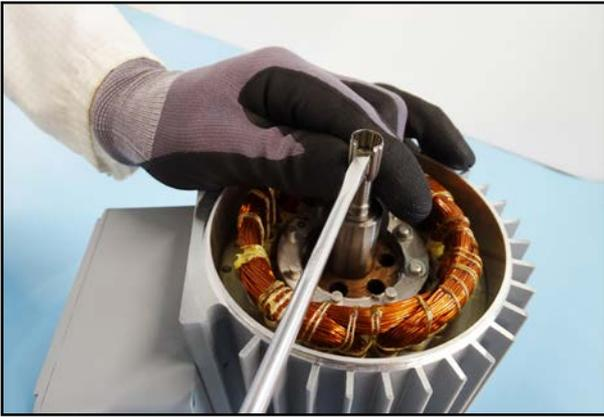
21. Schieben Sie mit Hilfe eines Schraubendrehers mit Flachklinge einen neuen Toleranzring über die Motorwelle.
