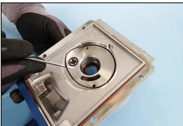
53. Entfernen Sie alle Dichtungen im Gehäuse.
