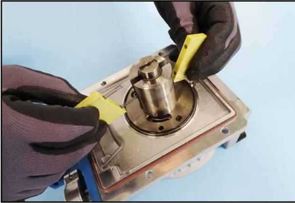
48. Ziehen Sie die Schieber aus dem Rotor.
