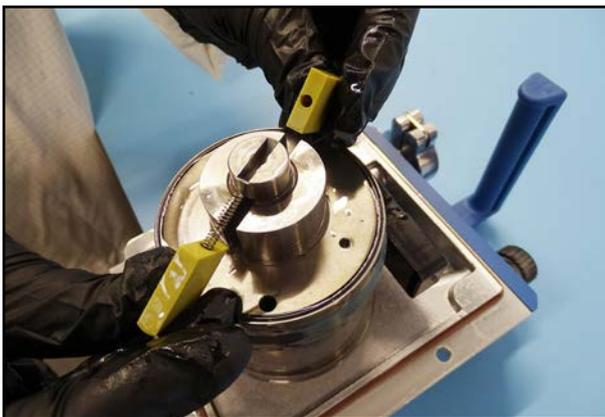
40. Ziehen Sie die Schieber aus dem Rotor.
