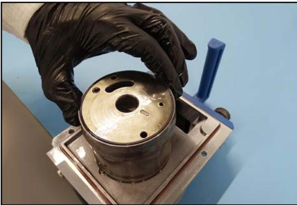
82. Setzen Sie das Zwischenlager ein.
