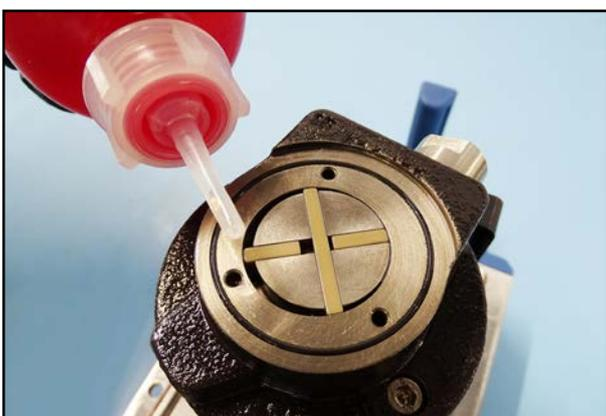
94. Füllen Sie den Raum um den Rotor mit dem Vakuumpumpenöl, mit dem Sie die Pumpe betreiben.
