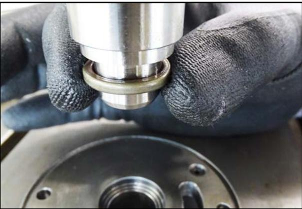
66. Spannen Sie den Einpressdorn 4 in eine Ständerbohrmaschine.
