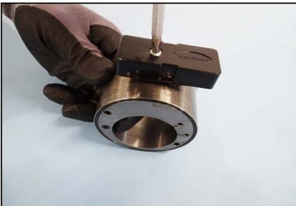
61. Schrauben Sie den Ölabscheider ab.
