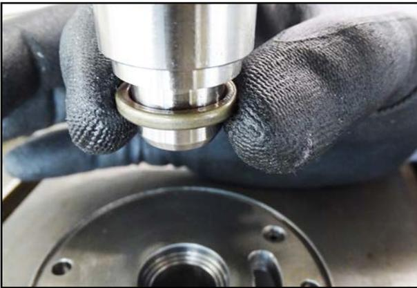
58. Spannen Sie den Einpressdorn 4 in eine Ständerbohrmaschine.
