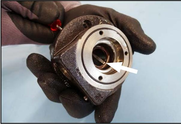
57. Drücken Sie die Wellendichtung mit Hilfe eines Schraubendrehers mit Flachklinge aus dem Lagerdeckel heraus.
