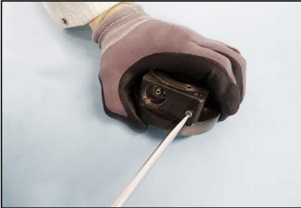
57. Schrauben Sie die Geräuschdämpfungsdüse aus dem Lagerdeckel.
