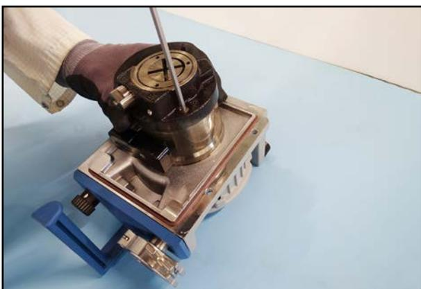
34. Drehen Sie die Schrauben am Aggregat heraus.
