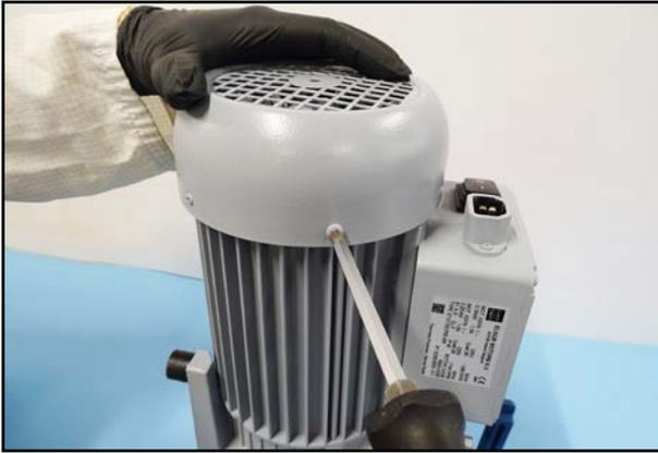
107. Fädeln Sie durch seitliches Kippen über das Lüfterrad die Lüfterhaube auf den Motorflansch.
