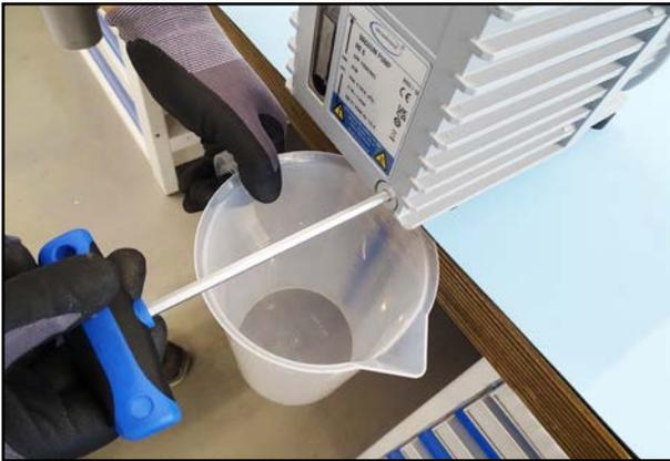
1. Drehen Sie die Ölablassschraube heraus und lassen Sie das Öl ab.
