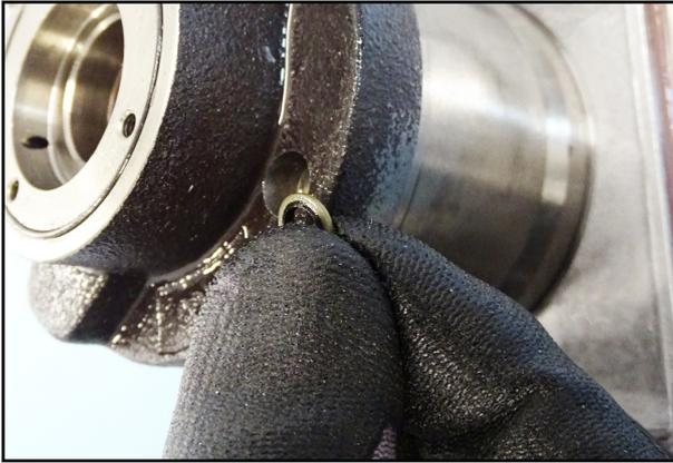
77. Legen Sie die Usit-Ringe in die Bohrungen des Lagerdeckels.
