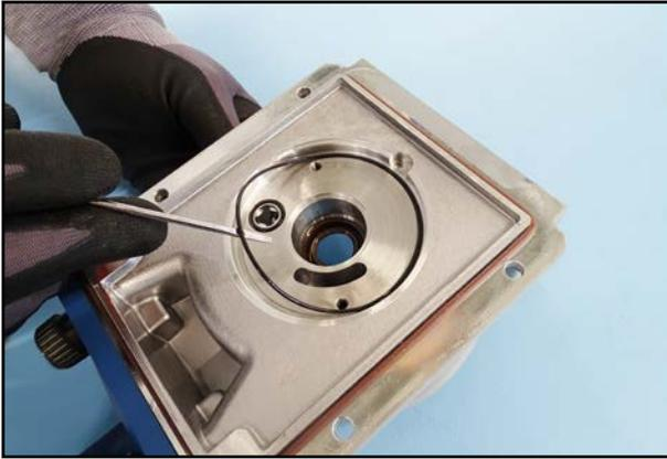
45. Entfernen Sie alle Dichtungen im Gehäuse.
