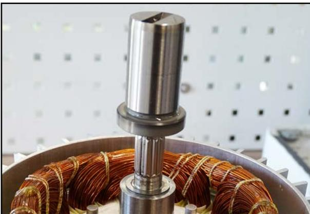
24. Setzen Sie die Kupplung auf die Motorwelle.
