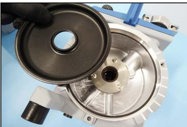
12. Heben Sie die Schutzwand aus dem Gehäuse.
