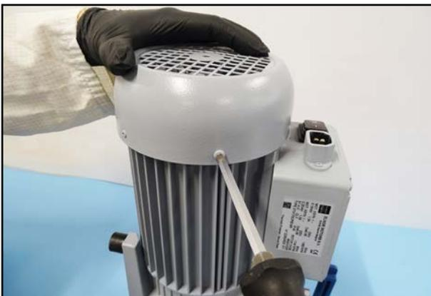
94. Fädeln Sie durch seitliches Kippen über das Lüfterrad die Lüfterhaube auf den Motorflansch.
