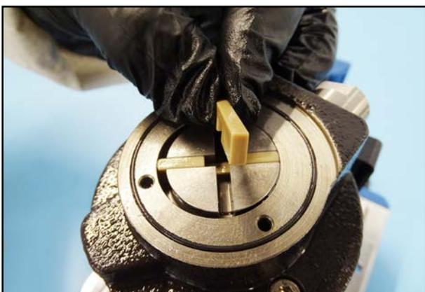
93. Setzen Sie die Schieber in den Rotor.
