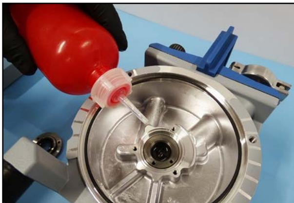
98. Füllen Sie den Raum vor der Wechselhülse mit dem Vakuumpumpenöl, mit dem Sie die Pumpe betreiben.
