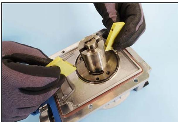
40. Ziehen Sie die Schieber aus dem Rotor.
