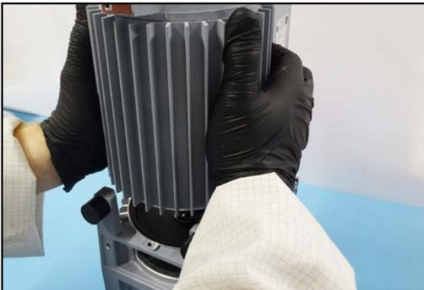
102. Setzen Sie den Motor vorsichtig in das Gehäuse.
