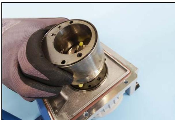
39. Heben Sie den Stator ab.
