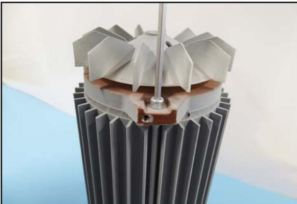
7. Lösen Sie die Schrauben.
