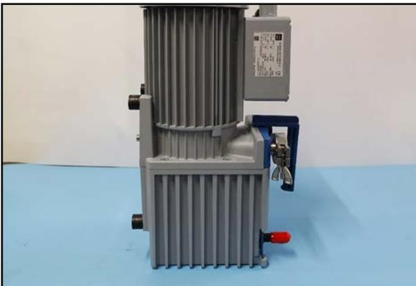
2. Stellen Sie die Pumpe auf den Ölkasten (auf das Typenschild).
